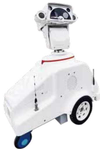
智能巡检机器人
